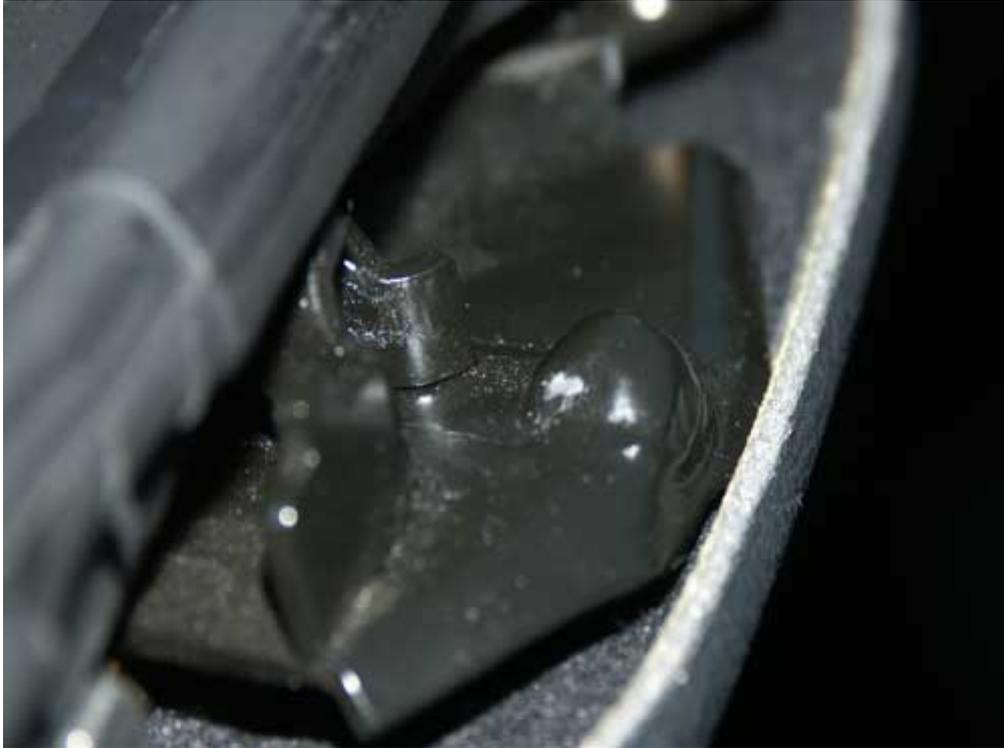
Von der Seite erkennt man deutlich, dass es Berührungen zwischen dem Dorn und dem Buckel auf dem Schließblech gibt. Sitzt das Dach nun nicht mehr stramm genug mit seiner vorderen Blechkante auf dem Dichtgummi des Frontscheibenrahmens auf, dann kann das Dach stärker arbeiten und der Dorn des Daches schlägt im geschlossenen Zustand auf welliger Fahrbahn an den Buckel an bzw. auf diesen auf.
