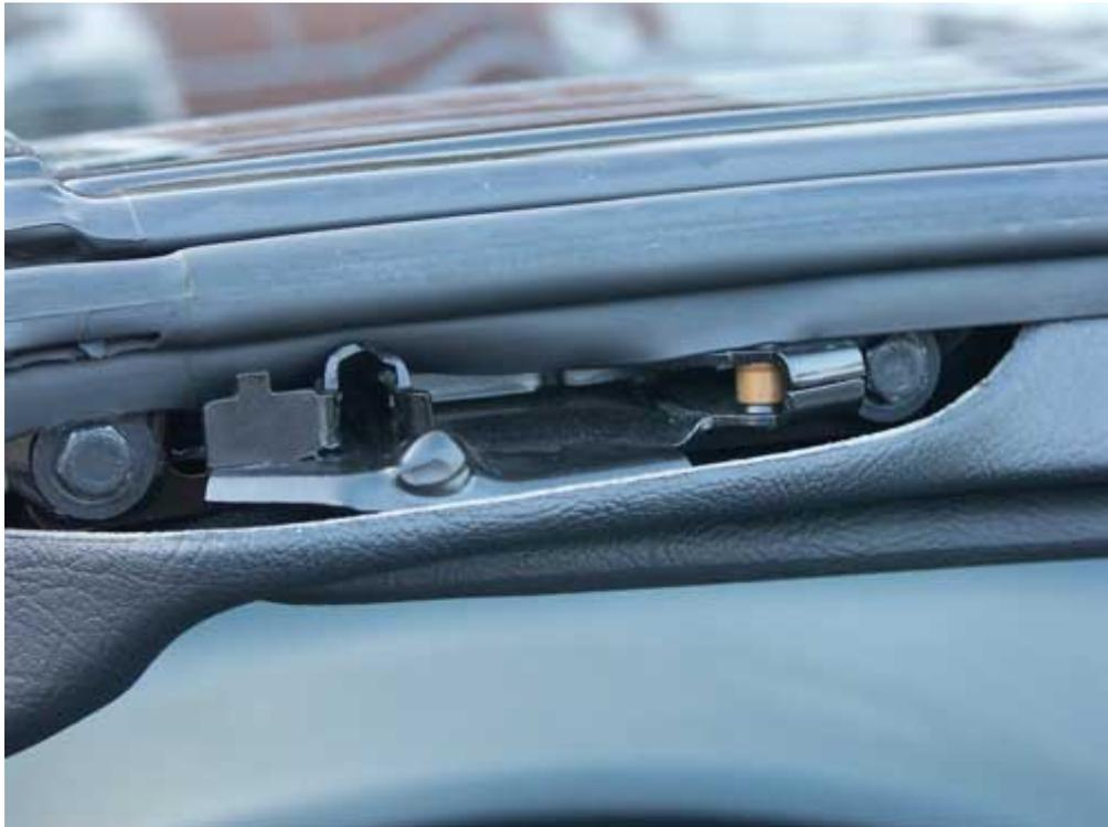
Man erkennt die beiden Befestigungsschrauben, die Aufnahme für den linken Dorn des Variodaches und rechts davor einen in das Dachschließblech gepresstem kleinen Buckel, der dafür sorgt, dass der Dorn beim Schließen des Variodaches die Aufnahme auch exakt trifft und nicht anstößt, wenn das Fahrzeug einmal nicht auf einigermaßen ebenem Boden steht.
