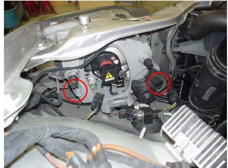
Vor dem Lösen der drei Schrauben (rote Kreise im Bild rechts) sollte man sich mit einem dünnen wasserfesten Stift die genaue Position des Scheinwerfers markieren. Hierzu habe ich bei den Schrauben den Übergang vom Karosserieblech zum Kunststoff des Scheinwerfers markiert um den Scheinwerfer beim Einbau wieder genau an die gleiche Position zu bringen.
