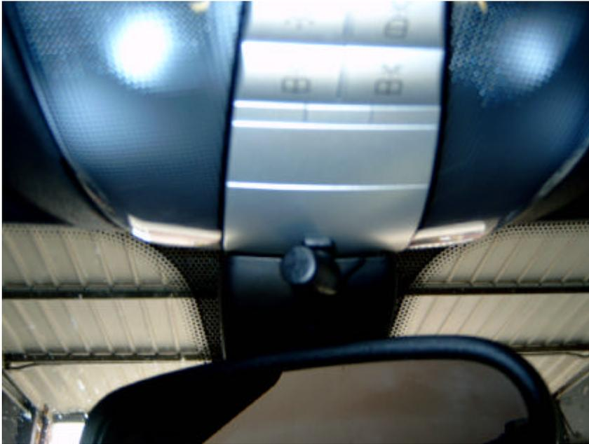
9.) Mikrophon mit dem Mitgelieferten Halter an die Innenleuchte kleben. Kabel hinter der Leuchte entlangführen.
