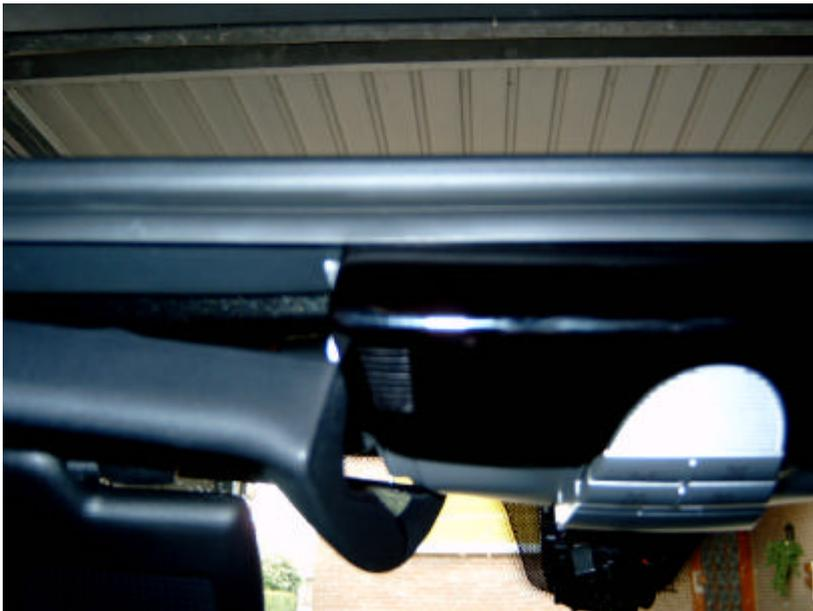
8.) Spiegel durch leichtes Ziehen entfernen. Nun noch die rechte Torxschraube der Sonnenblende auf der Fahrerseite entfernen und Abdeckung nach unten ziehen. Dort wird dann das Kabel des Mikrofons sichtbar.
