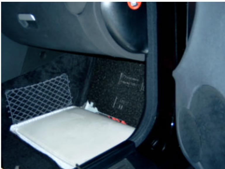
3.) Teppich nach vorne klappen, Styropor durch nach oben schieben lösen und entfernen.
