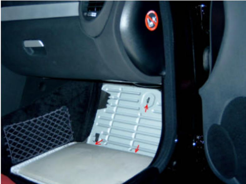
4.) Die 3 markierten Muttern entfernen und das Blech entnehmen.
