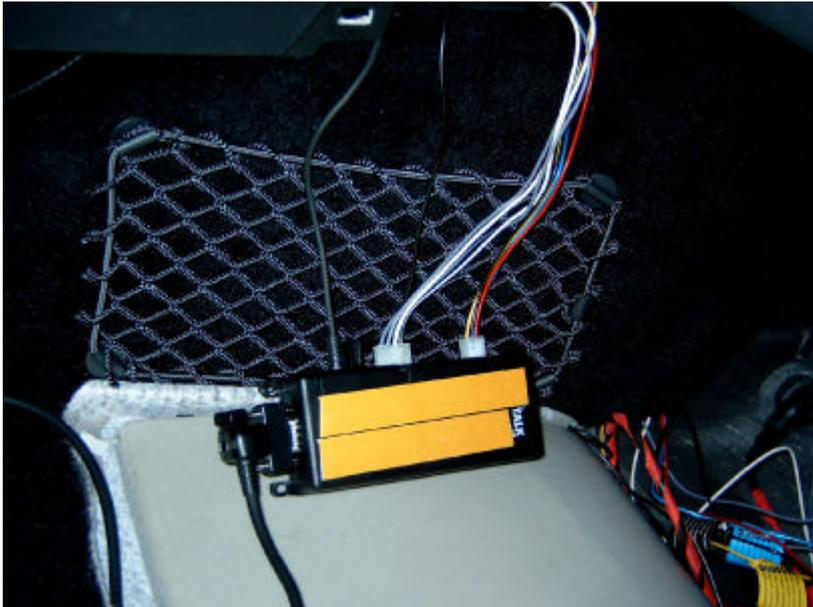
7.) Kabel in die Box stecken. Mikrofonstecker mit Lasche sichern. Kabel der Telefoneinheit anschrauben. Antennenkabel an die Telefoneinheit schrauben. Doppelklebeband auf die Box kleben.
