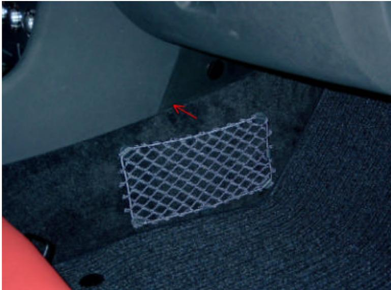
2.) An der Mittelkonsole befindet sich ein verdeckter Klipp der nach vorne gezogen werden muss. Dazu hinter die Abdeckung fassen und nach vorne ziehen. Danach die Abdeckung herunterklappen und entfernen.
