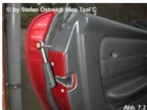
Nun kann die Verkleidung von unten her abgewinkelt werden. Sie ist mit Klemmen befestigt und oben nur eingehängt. Kräftig ziehen, aber nicht mit aller Gewalt abreißen, denn es ist noch der Bautenzug der Türetriegelung befestigt, sowie das Kabel des Hochtöners. Den Bautenzug einfach nach oben aus der Halterung ziehen. Das Kabel des Hochtöners trennen (Steckverbindung).
