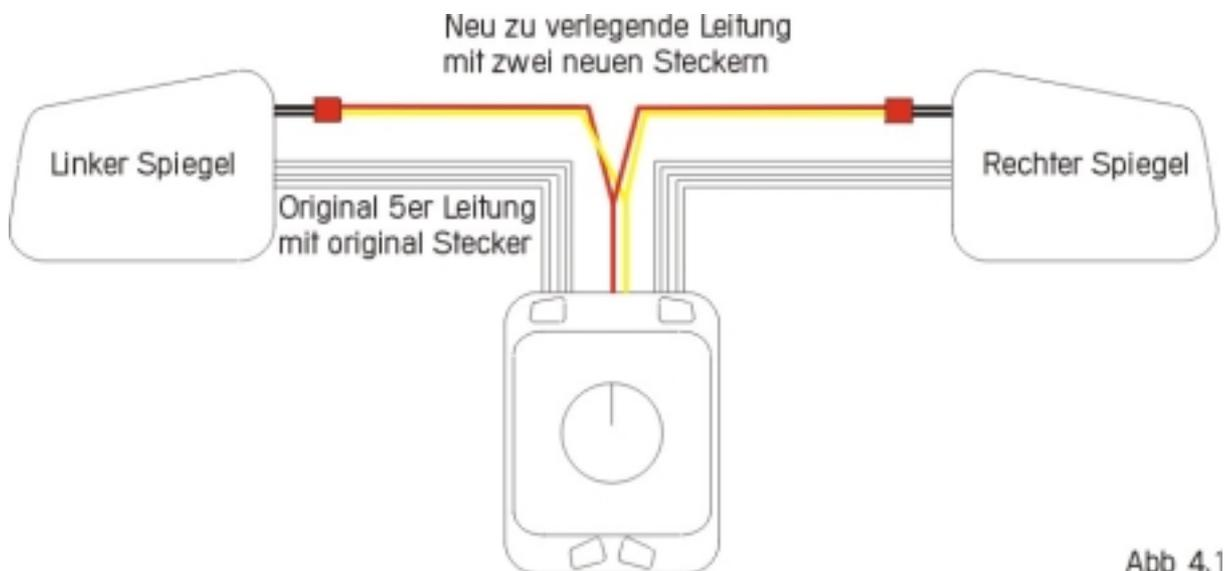
Anmerkung zu Abb.1.1 : Beim Spiegelblinker 6 adriges Originalkabel. Beim Umrüsten auf Blinker müsste diese 6 Leitung nachgerüstet werden.
