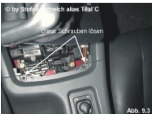
Darunter befinden sich die zwei Kreuzschlitzschrauben. Diese entfernen Abb. 9.3
