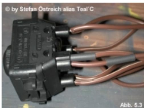
An die Kabel werden die Buchsen (Conrad 845299-88) angelötet Schrumpfschlauch nicht vergessen um die Hülsenschäfte zu schützen. Anschließend die Buchsen in die Steckerbuchse einstecken. Sie rasten dann ein. Abb. 5.4 – 5.6
