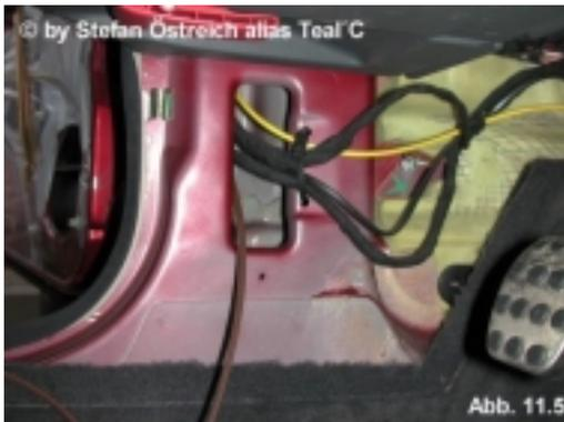
Auf der der Beifahrerseite genauso verfahren, allerdings geht es da noch einfacher, weil keine Pedale im weg sind. Die Kabel können unter der Bodenplatte, wo auch der BOSE-Verstärker sitzt verlegt werden, einfach dem schon verlegten Kabelbaum folgen, bis man in der Mittelkonsole am Schaltknäuf ankommt.
