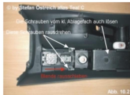
Wenn die Schrauben gelöst sind, kann die Blende herausgeschoben werden, Schalter entfernen (sind nur eingeklickt), neuen Schalter einsetzen. Alles wieder verschrauben. Die Konsole bauen wir erst wieder ein, wenn die neuen Kabel verlegt sind.
