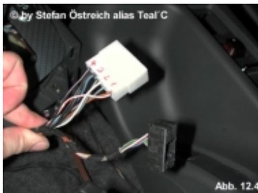
Nun die beiden neu verlegten Leitungen zusammenlöten und mit dem 2er Stecker versehen wie den 8er.
