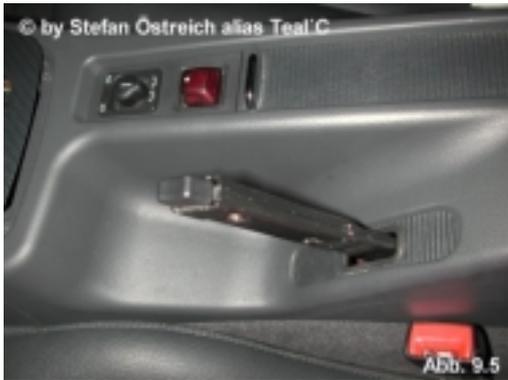
Jetzt kann die Mittelkonsole abgehoben werden. Aber Vorsicht es hängt unten noch der Unterdruckschlauch für das Schloss der Mittelkonsole dran. Diesen ertasten und abziehen. Achtung diese Klickverschlüsse sitzen unheimlich fest. Ich habe mir eine Kupplung abgebrochen. Dann die drei Kabelanschlüsse abziehen. Vom Zigarettenanzünder, Dachöffner und Spiegelschalter. Jetzt kann die Mittelkonsole herausgenommen werden.
