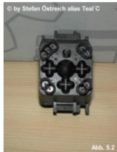
An die PIN's siehe Abb. 5.2 werden nun neue Kabelstücke gelötet. Über die Kontakte werden Schrumpfschläuche gezogen und erhitzt Abb. 5.3
