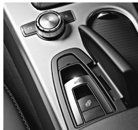
Dach-Bedieneinheit und zentrales Bedienelement
